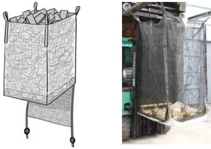
90 x 90 x 165 cm / SWL 1'000 kg / SF 6:1 / aus schwarzem Gittergewebe / oben offen / mit Auslaufschürze / Bodenklappe / 2 Verschlussringe / 4 Schlaufen 30 cm freie Länge 3530-6864
