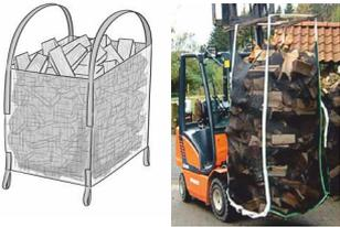
90 x 90 x 165 cm / SWL 900 kg / SF 5:1 / aus schwarzem Gittergewebe / oben offen / Boden geschlossen / 2 Schlaufen 120 cm freie Länge / 4 Bodenschlaufen 30 cm freie Länge 3530-4695
